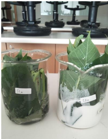
Proses Maserasi Daun Singkong dengan larutan \text{NaHCO}_3 dan larutan \text{Ca(OH)}_2
