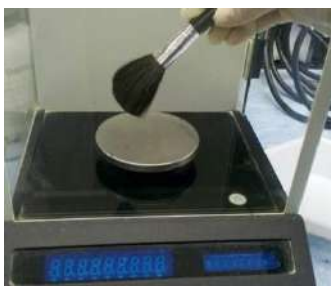
Gambar. Membersihkan neraca analitik dengan kuas (Sumber: https://blogkimia.com/cara-merawat-alat-laboratorium/ )
