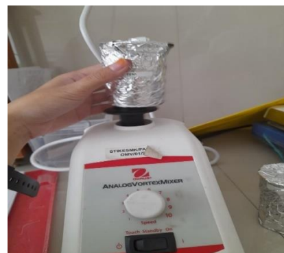
Pembungkusan dengan aluminium foil Penghomogenan dengan vortex mixer
