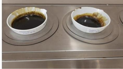
Ekstrak cair setelah di rotary evaporator di uapkan untuk mendapatkan ekstrak kental
