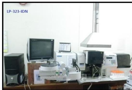
alat spektrofotometri serapan atom
