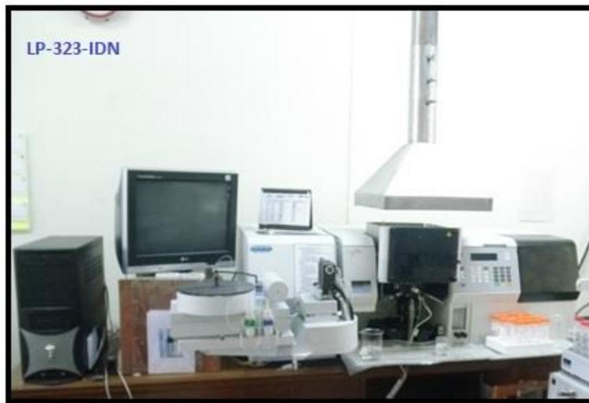
(gambar 3 alat spektrofotometri serapan atom)
