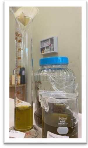
Proses penyaringan maserasi kulit nanas hijau
