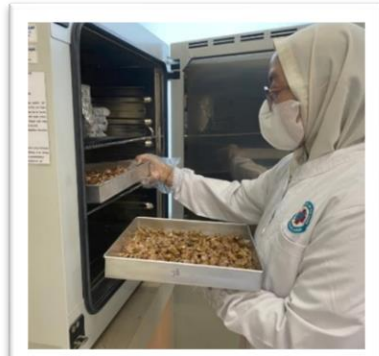
Pengeringan sampel dengan oven
