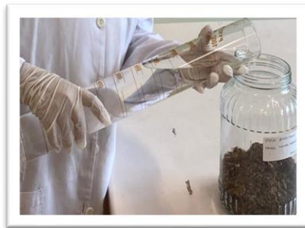
Tambahkan pelarut etanol 96% sebanyak 1.000 mL
